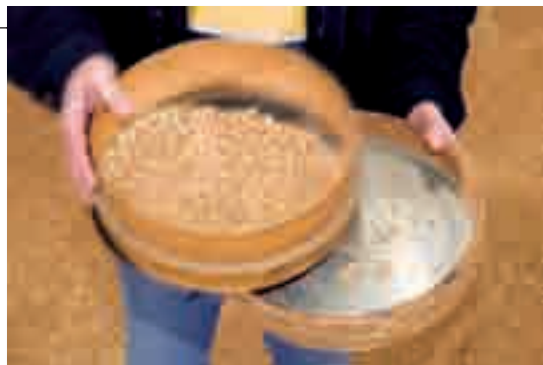
El tamizado es utilizado para separar granos de acuerdo a su tamaño.
